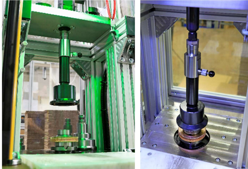
Close-up van de lichtgordijnbeveiligde PST-servopers bij het verbinden van de transmissiecomponenten bij GfA ELEKTROMATEN GmbH in Düsseldorf - voor (groen licht, links) en direct na het persproces, wanneer de persstempel weer omhoog wordt gebracht.
